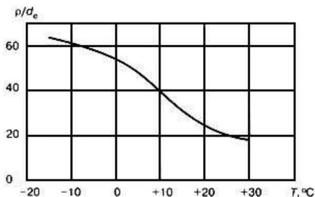
Рисунок 18 - Зависимость отношения радиуса упругого изгиба газопроводов к наружному диаметру трубы от температуры окружающего воздуха при монтаже и укладке газопроводов
