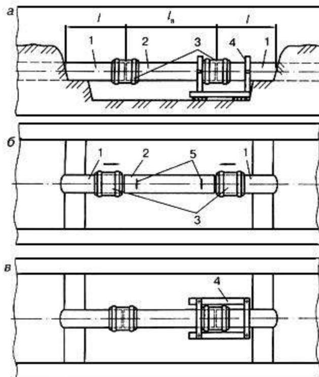
1 - концы газопровода; 2 - трубная вставка; 3 - муфты; 4 - позиционер для сборки соединения; 5 - метки установки муфт; - длина освобождения концов газопровода; - длина вставки
