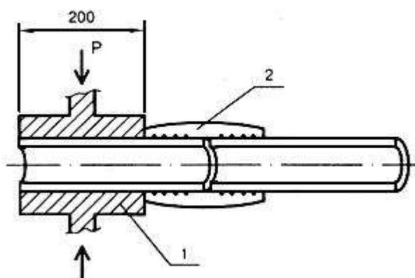
1 - обжимные плиты; 2 - испытываемый образец
