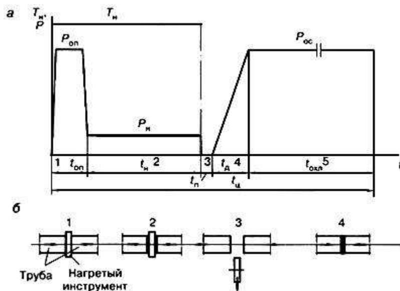
*a* - диаграмма изменения во времени давления на торцах и температуры нагретого инструмента ; *б* - последовательность протекания процесса сварки;
