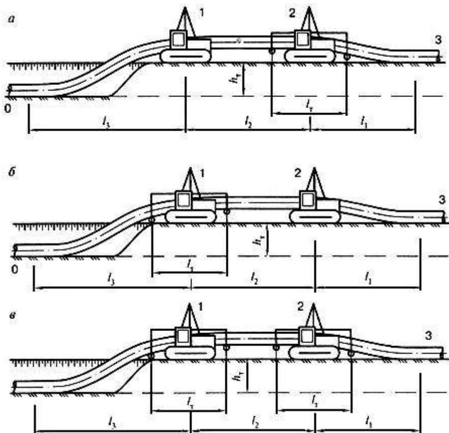
*a* - с траверсой головного трубоукладчика; *б* - с траверсой у заднего трубоукладчика; *в* - с траверсами у обоих трубоукладчиков;
