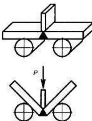
Рисунок Ф.1 - Схема испытания на статический изгиб
