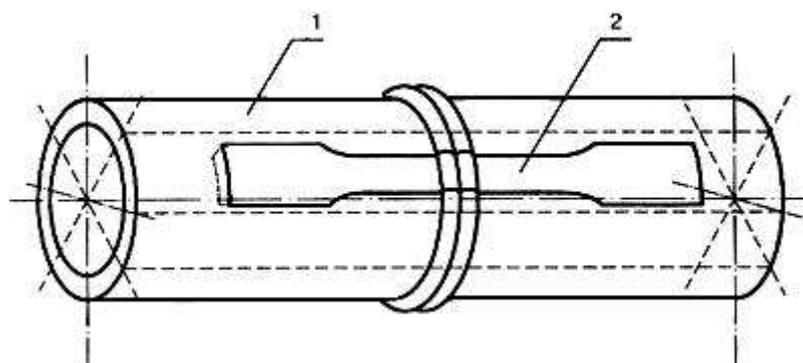
1 - патрубок со сварным соединением; 2 - расположение образцов
