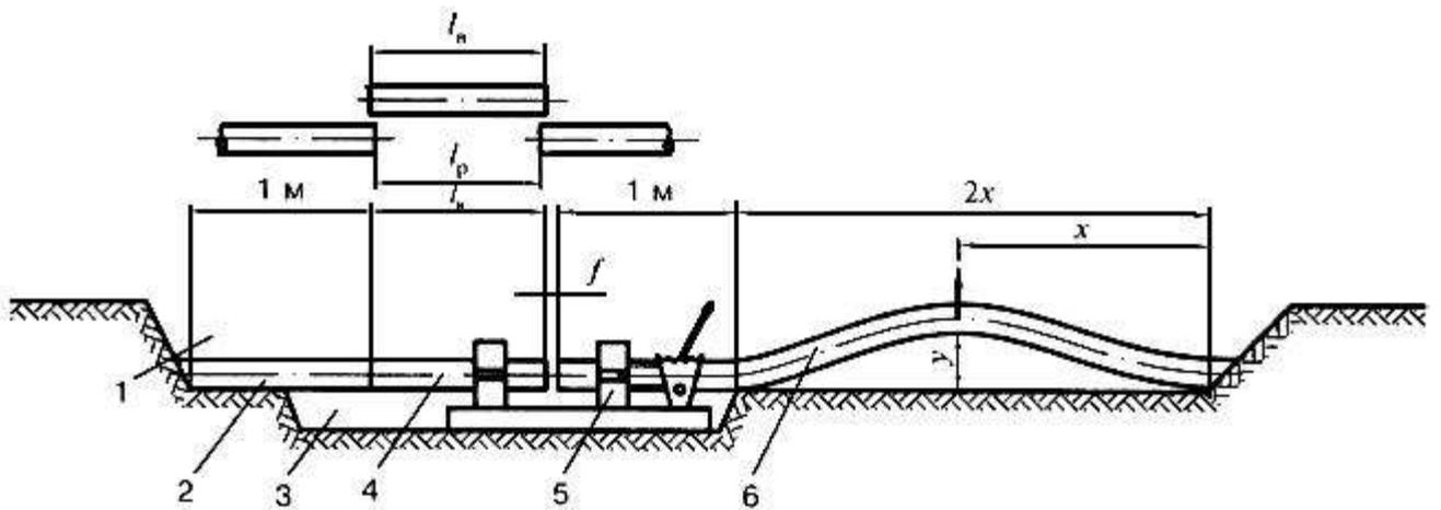
1 - траншея; 2 - неподвижный конец газопровода; 3 - прямок; 4 - вставка; 5 - сварочная машина; 6 - подвижный конец газопровода
