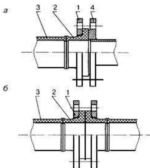
*а* - полиэтиленовых труб со стальными трубами, арматурой; *б* - полиэтиленовых труб между собой;
